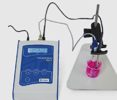
**Medidor de pH microprocessado**
